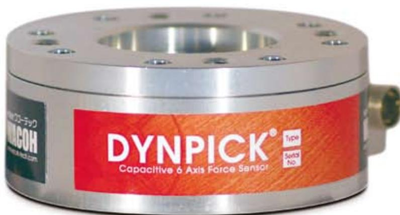
Dyn Pick® (静電容量型6軸力覚センサ)は、6方向の力(Fx・Fy・Fz・Mx・My・Mz)を同時に検出することができる力覚センサです。従来の力覚センサにはなかった独自の構造・設計により、過負荷対策としてストッパー構造をセンサ内部に取り入れました。
